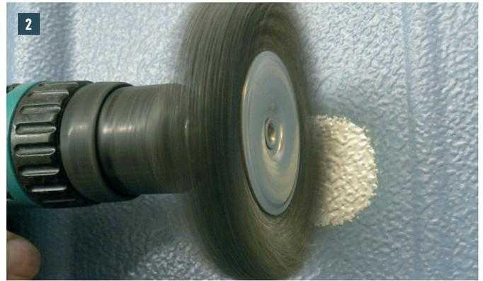
**2** Bohrmaschine mit Drahtbürste zum Entfernen der Farbe. **ACHTUNG:** Zum Löten muss das Aluminium blank und fettfrei sein.
