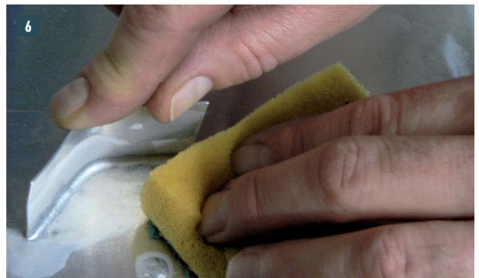
**6** Flussmittel löst die Oxydschicht von Aluminium auf und muss daher restlos entfernt werden. Mit Schwamm und Wasser oder mechanisch.
