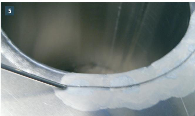
**5** Durch Einbringen von Wärme gibt es in jedem Werkstück Spannungen. Dadurch ist es notwendig die zu verbindenden Stücke so vorzubereiten, dass diese nicht ausweichen können (falzen, bördeln, schweifen, sicken).
