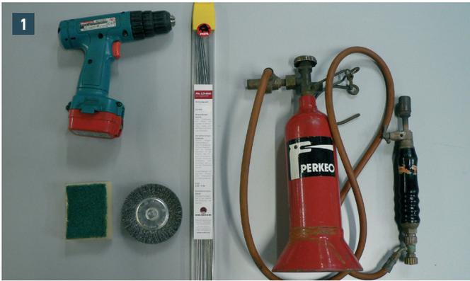
**1** Benötigtes Werkzeug für die feste und dauerhafte Verbindung von Aluminium.
