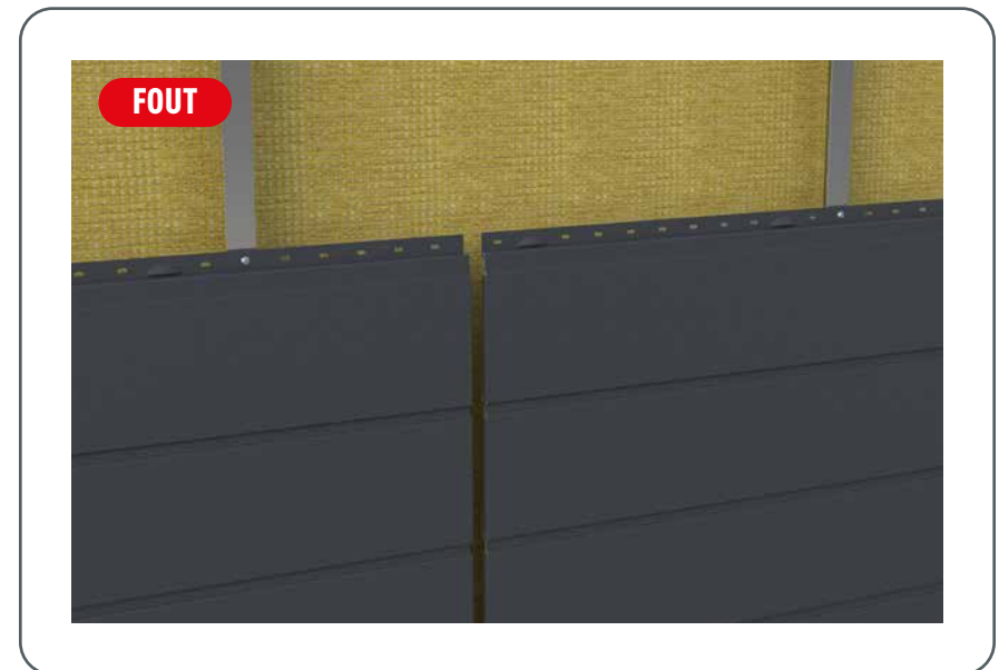
Afbeelding 92 • Open stootvoegen niet ok
