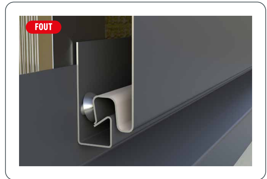
Afbeelding 77 • Bevestiging startprofiel niet in orde
