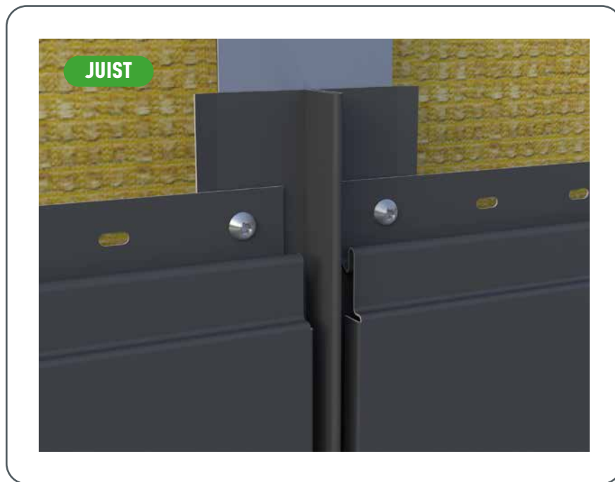
Afbeelding 91 • Montage met duwplaat
