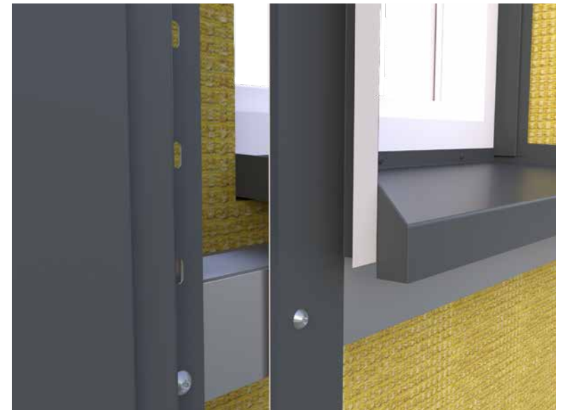
Afbeelding 96 • Montage verbindingshoek raamopening
