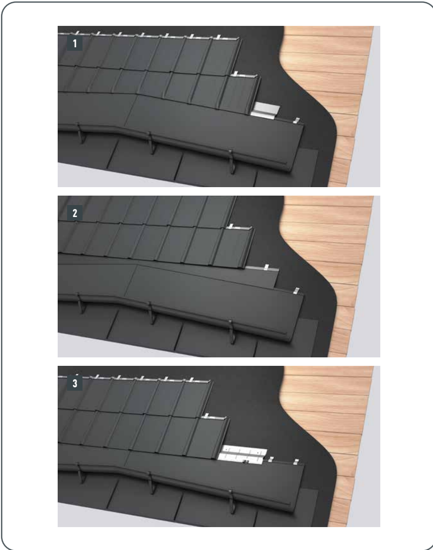
Abbildung 74 • Anschluss an eine Saumrinne
